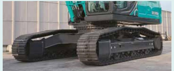
■ Fuerza de tracción de la barra de tracción: **280 kN**
