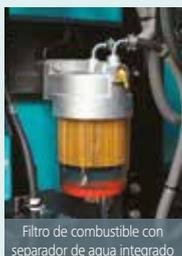
Filtro de combustible con separador de agua integrado
