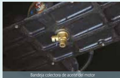
Bandeja colectora de aceite del motor
