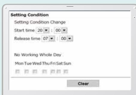
Alarma de arranque del motor fuera del tiempo de trabajo determinado
