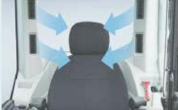
El aire acondicionado de gran tamaño tiene rejillas en las columnas posteriores que soplan desde atrás y hacia la izquierda y derecha del asiento del operador. Pueden ajustarse para dirigir un flujo directo de aire frío/caliente hacia el operador, lo que implica un entorno operativo más cómodo.
