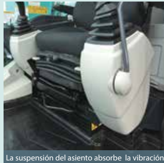
La suspensión del asiento absorbe la vibración
